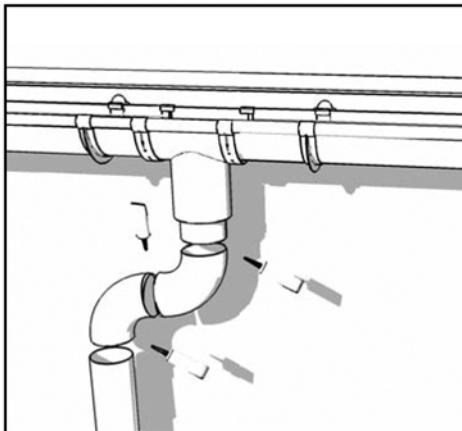
При монтаже центральной воронки, начните установку желоба от нее. 1 Сначала Вы защелкиваете заднюю часть желоба (1), затем внешнюю (2). Маркировки (ограничители) внутри воронки указывают промежуток, который должен оставаться, чтобы компенсировать термическое смещение элементов.
