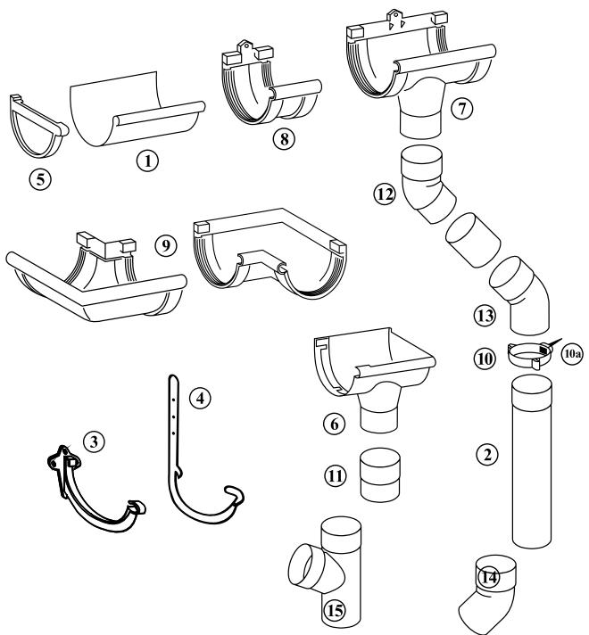
Определите позицию воронки. Это автоматически самая нижняя точка. После этого, Вы можете также определить самую верхнюю точку. Установите кронштейн в самой нижней и один в самой верхней точке. Мелованная нить, натянутая между обоими кронштейнами поможет в установке остальных кронштейнов.
